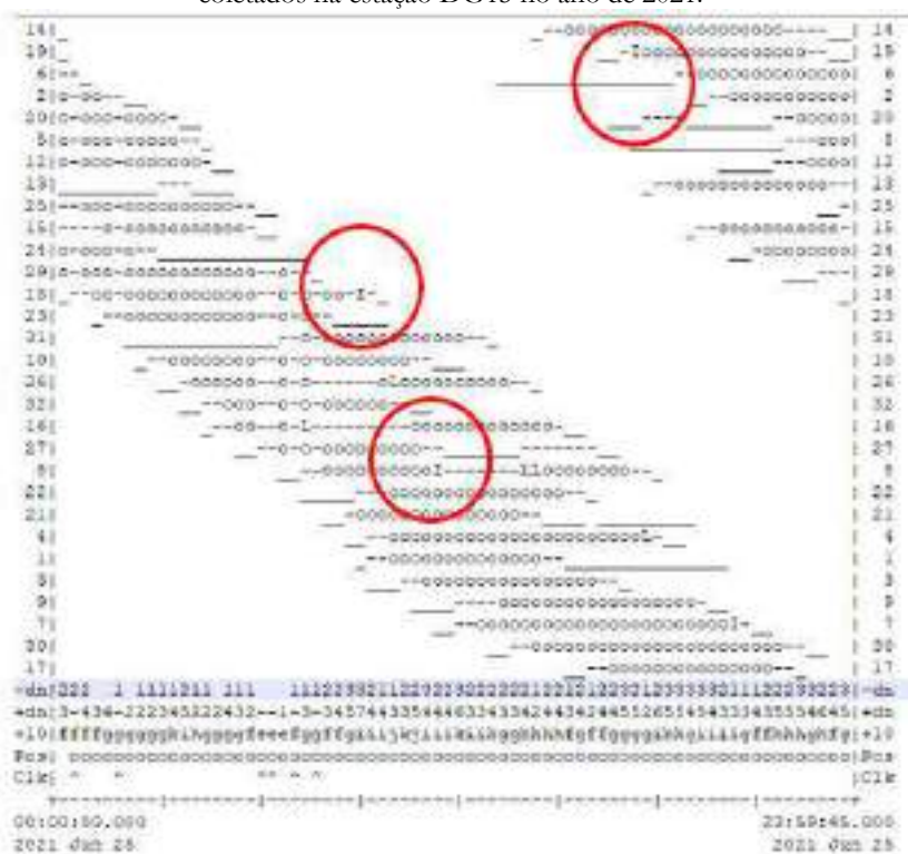
Figura 6. 11 - Plot gerado pelo programa TEQC indicando a atuação de efeitos ionosféricos nos dados GPS coletados na estação DG15 no ano de 2021.
