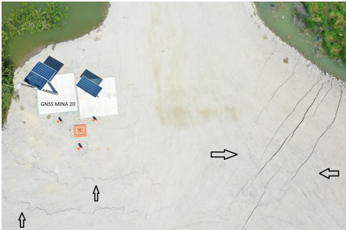
Figura 5 - DIA 29. Registro da boca do poço da cavidade 18. Fraturas ao redor e base de concreto rachada.
