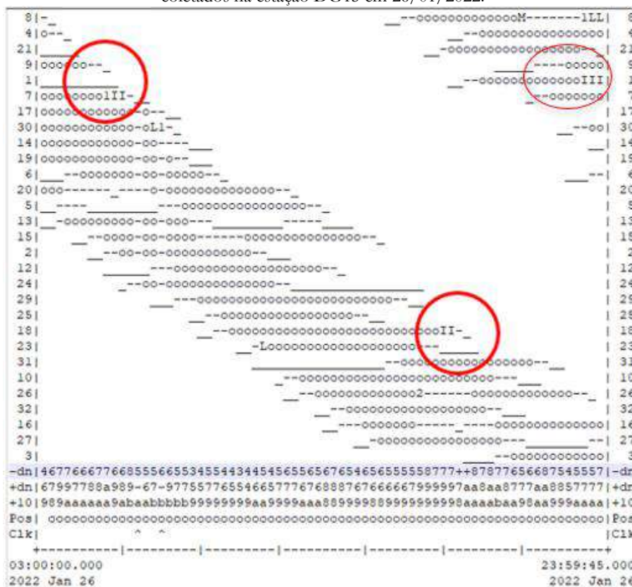
Figura 6. 20 – Plot gerado pelo programa TEQC indicando a atuação de efeitos ionosféricos nos dados GPS coletados na estação DG15 em 26/01/2022.
