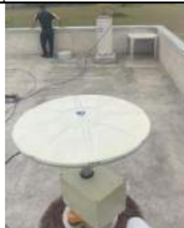
5d) Antena TRM 11.5000 a ser calibrada instalada acima do robô, no Pilar 2000 da BCAL
