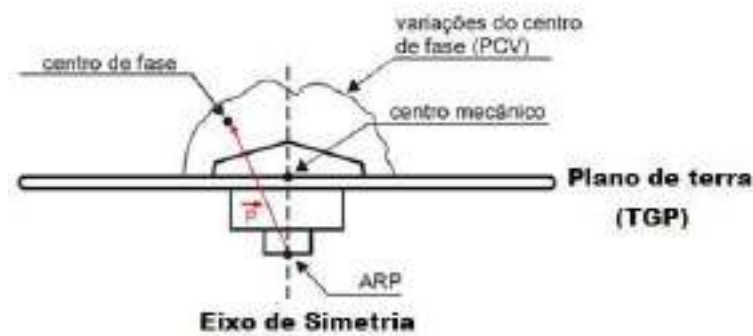
Figura 2. 1- Elementos de uma Antena GNSS
