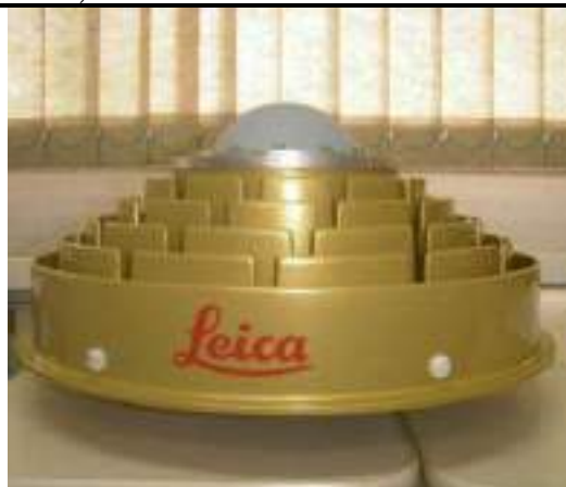
5c) Antena de Referência LEIAR25 instalada no Pilar 1000 da BCAL
