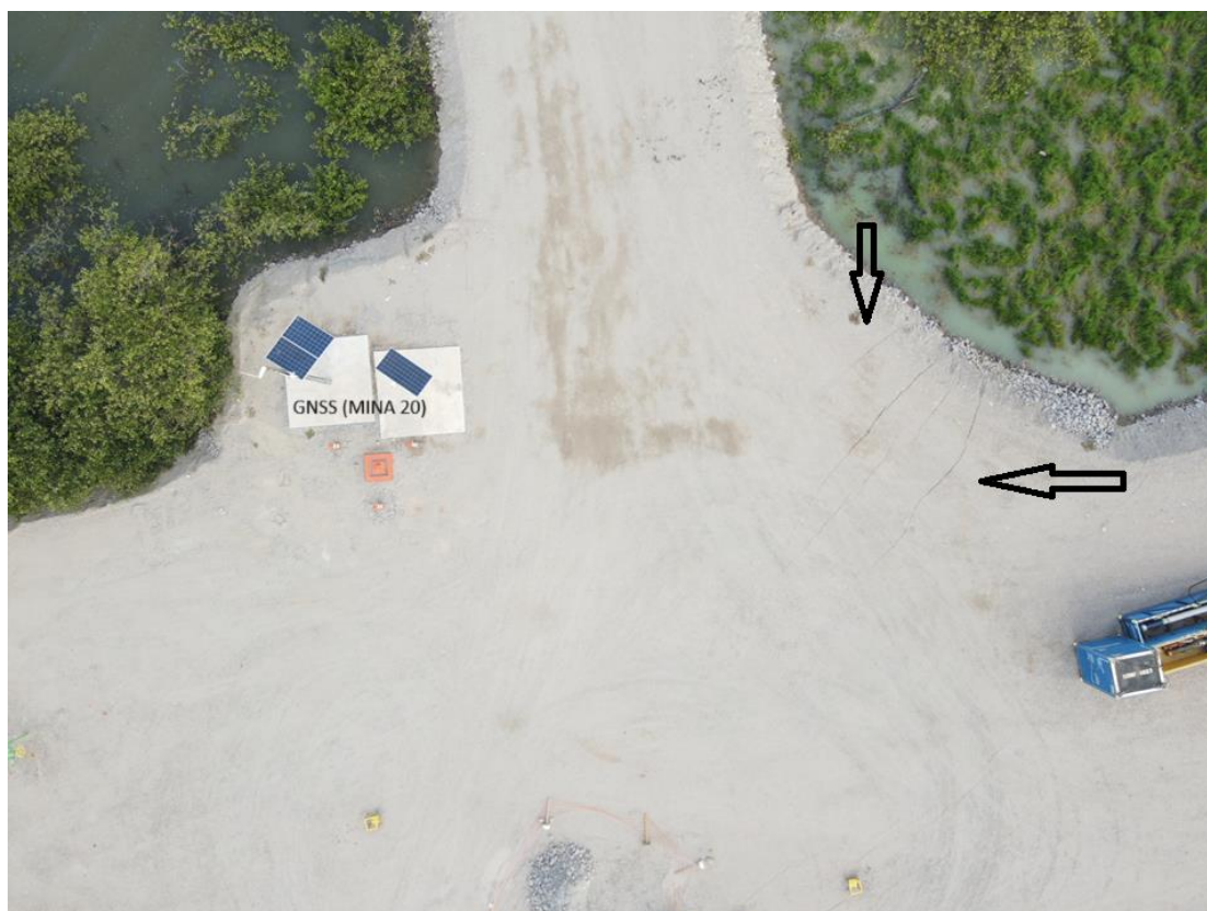
Figura 3 - DIA 29 - Área projetada da cavidade 18. Setas indicam as feições de fraturamento
