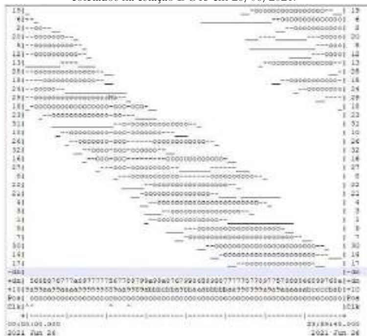
Figura 6. 19 – Plot gerado pelo programa TEQC indicando a atuação de efeitos ionosféricos nos dados GPS coletados na estação DG15 em 26/06/2021.
